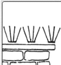
Kuş kondurmaz monte edilecek yüzey geniş ise 2 yada bazen 3 sıra kuşkondurmazın yan yana monte edilmesi gerekebilir. Bu durumda kuşkondurmazlar arası mesafe 5 cm'den fazla olmamalıdır.
